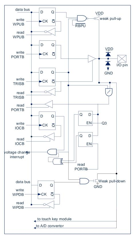
Fig. 6-2: I/O structure diagram (2).
